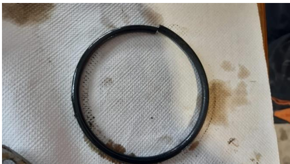
Hélice déposée et joint défectueux
