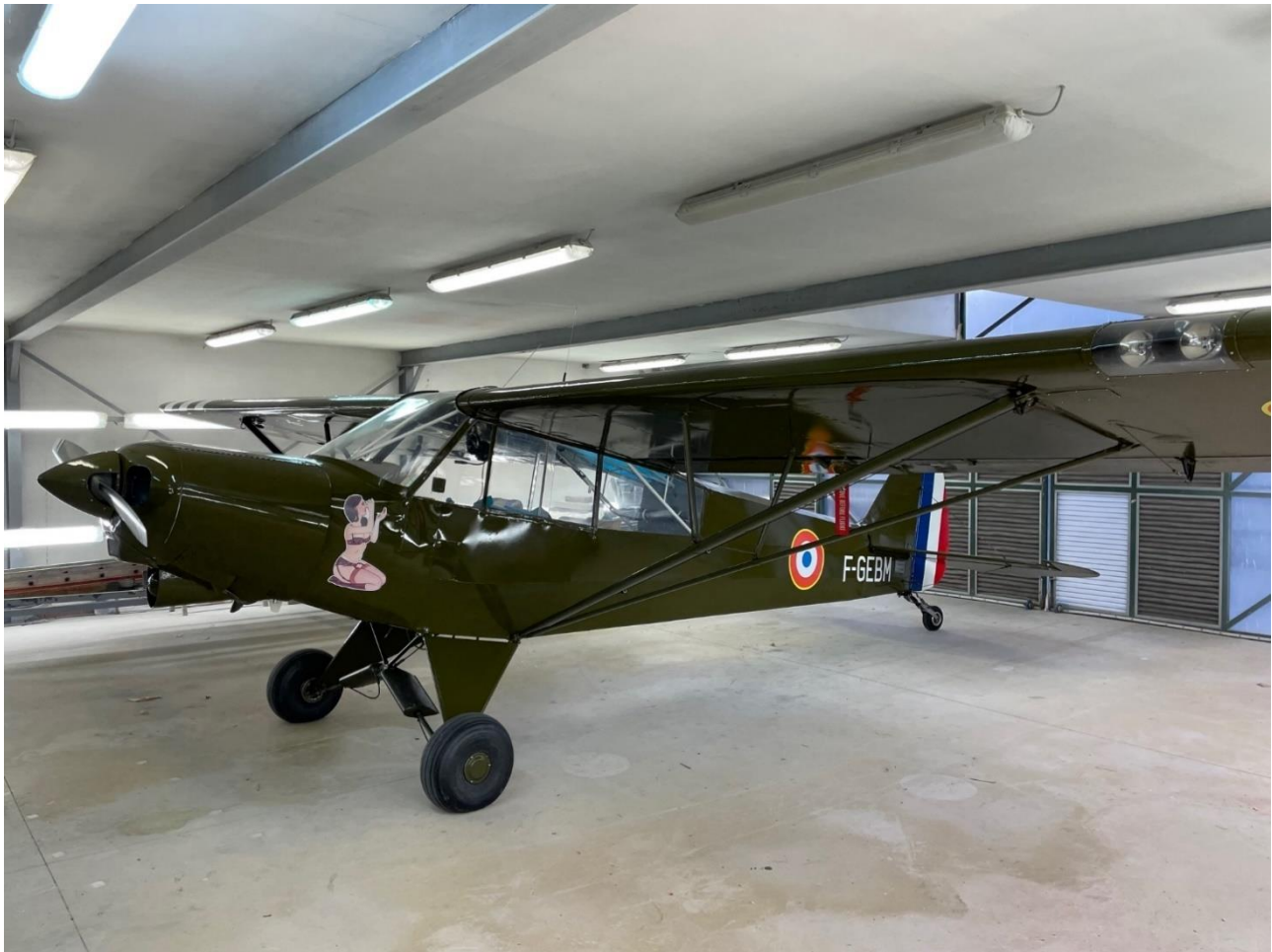
Piper PA18-150 F-GEBM après rentoilage et peinture
